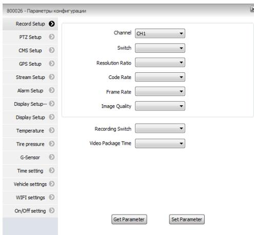
RecordSetup – Параметры записи (расширение, качество, количество кадров в секунду, время ролика)
