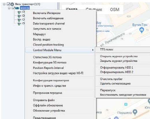
Присутствует возможность удаленно перезапускать устройство, восстанавливать заводские установки, форматировать HDD, посмотреть статистику 3g,экспортировать статистику 3g, производить конфигурацию потока 3g, изменять интервал обновления GPS
